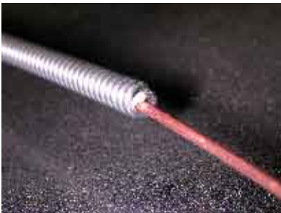
Fig. 2 Conducto Flexible (Liner) mal cortado con puntas que agregan rozamiento al alambre.
