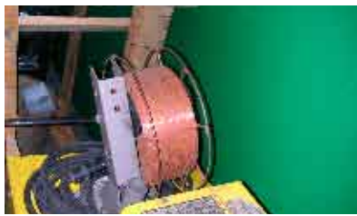
Fig. 4 Alambre oxidado. Si se estima que el alambre no va a consumirse en poco tiempo, se debe considerar el almacenamiento en condiciones controladas
