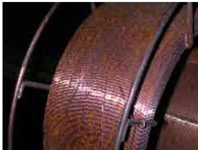
Fig. 4 Alambre oxidado. Si se estima que el alambre no va a consumirse en poco tiempo, se debe considerar el almacenamiento en condiciones controladas
