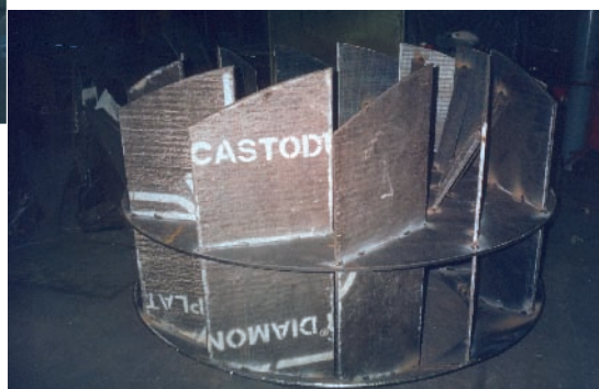
Subconjunto de álabes ↘ fabricados con placas CDP
