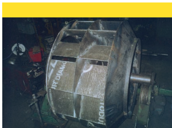
↘ Conjunto Ventilador terminado, realizado con placas antidesgaste CDP
