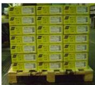
Figura 1: Apilamiento máximo de ocho cajas en posición horizontal.
