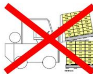
Figura 3: Diseño esquemático del apilamiento de pallets con apoyo inclinado.
